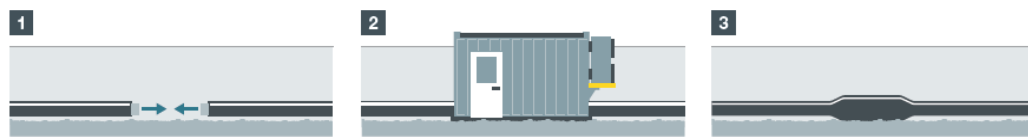
Abbildung 4: Schematische Darstellung der Kabelverbindungen (Muffen) 4
